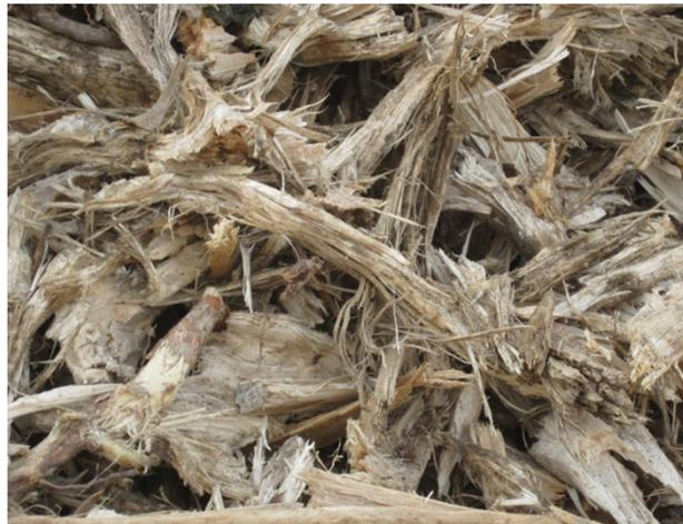
links 300er Span mit Überlängen bis 600 mm,
