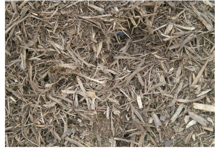
150 iger Span Wurzelschredder oben 1x gesiebt
